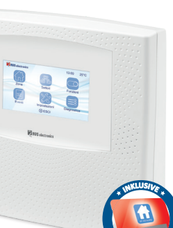
RAPTOR RT ( oben ) – Funk-Alarmzentrale mit integriertem GSM/GPRS- Übertragungsgerät, Touch- Bedienteil und 1 Jahr Premium-App „MyAVSAlarm“ inklusive.
